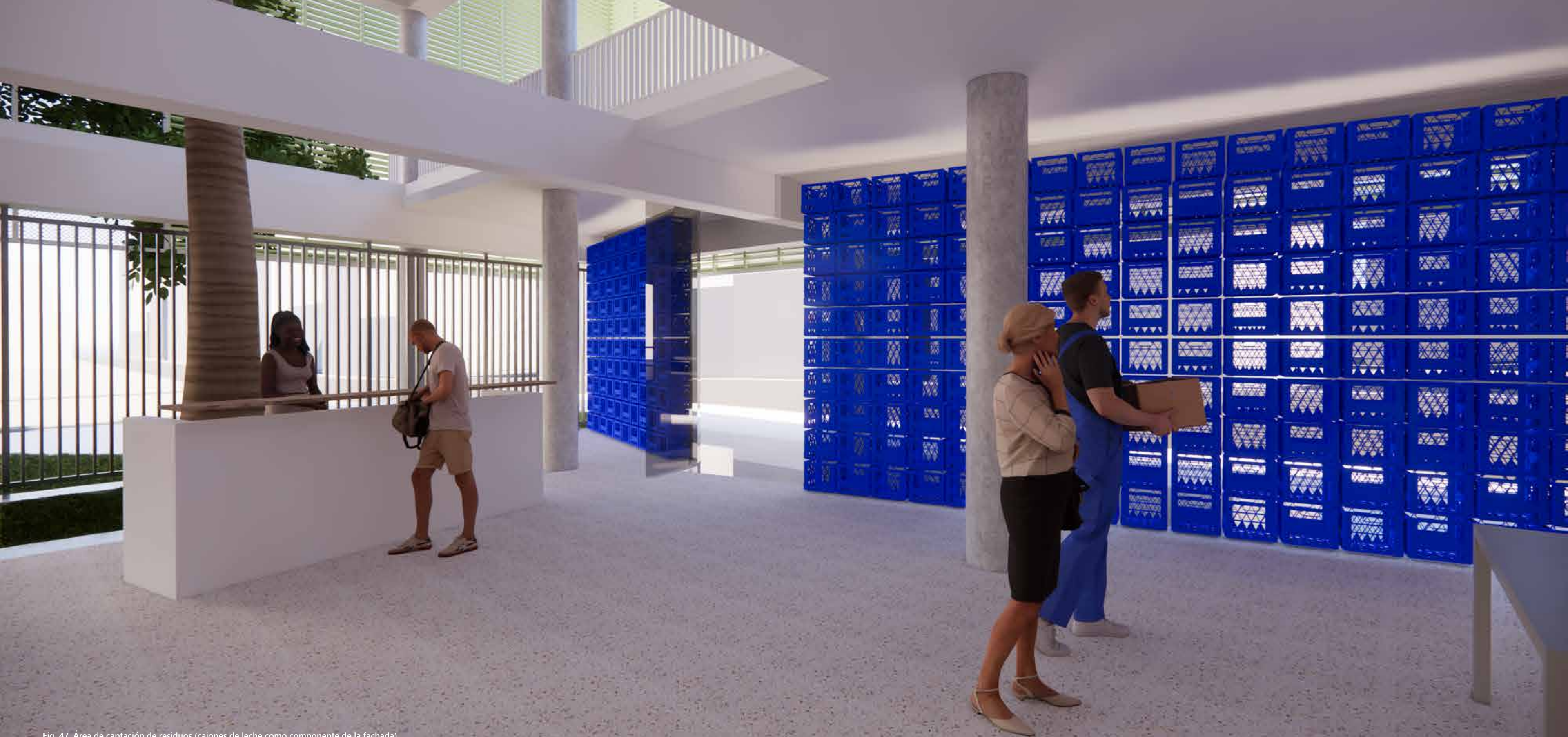
Fig. 47. Área de captación de residuos (cajones de leche como componente de la fachada)
