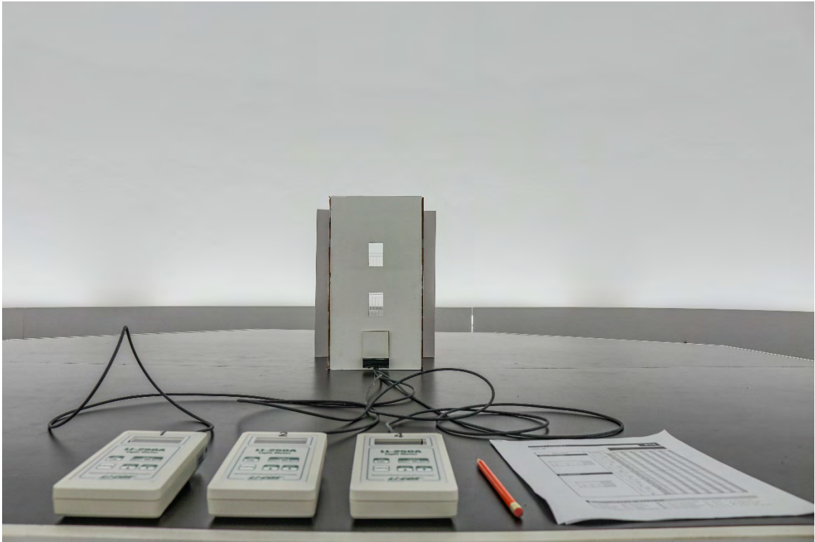
Figura 4.8 Maqueta en la Tropiesfera con los sensores fotométricos
