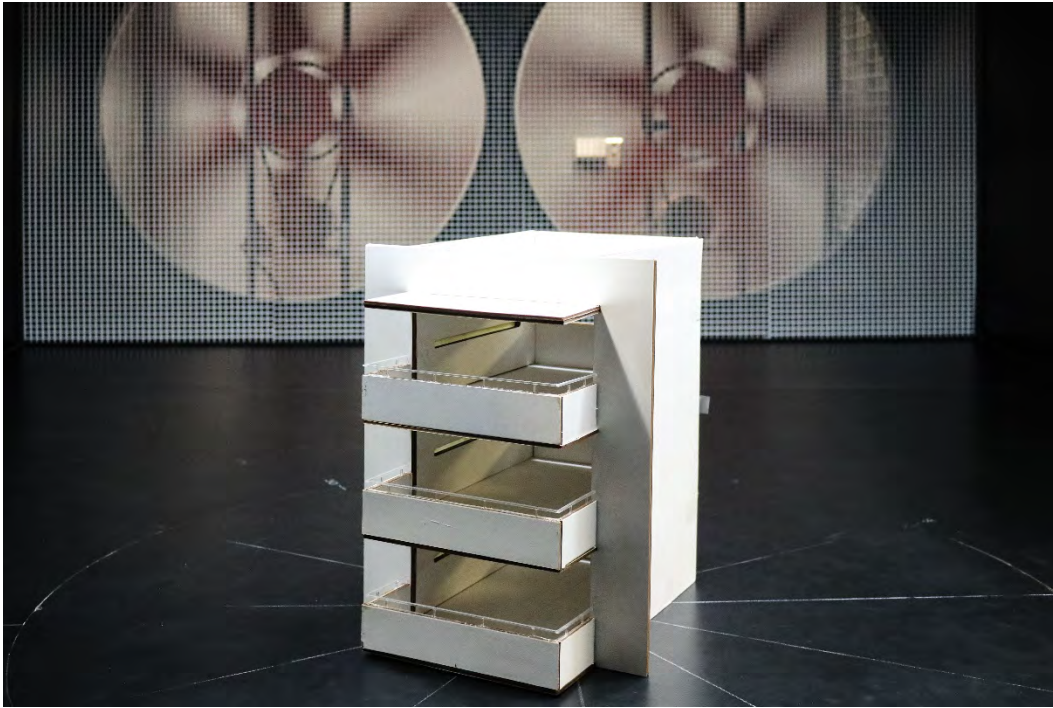
Figura 4.5 Maqueta con anemómetros en Túnel de Viento
